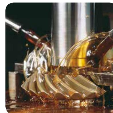
Sono prodotti a base di olio minerale più esteri e speciali additivi lubrificanti. Contengono anche antiossidanti e inibitori di corrosione per preservare i manufatti e la macchina utensile.
