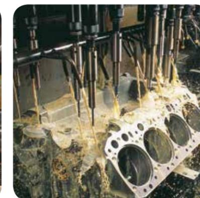
Contengono olio minerale miscelato ed esteri di varia origine e additivi di taglio EP. Alcuni prodotti sono basati totalmente su esteri. Completano il prodotto, gli additivi detergenti, biostabilizzanti ed anticorrosivi.
