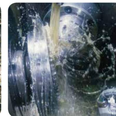
Questi lubrificanti sono esenti da olio minerale e sostanze untuose. Non possiedono un potere lubrificante ma hanno eccellenti proprietà antiruggine e raffreddanti.
